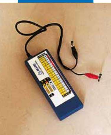
Elektroninis drėgmomatis drėgmės lygiui matuoti Mapecem išlyginamuosiuose sluoksniuose
