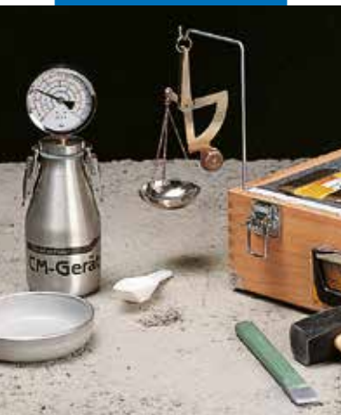
Karbidinis drėgmomatis drėgmės lygiui matuoti Mapecem išlyginamuosiuose sluoksniuose
